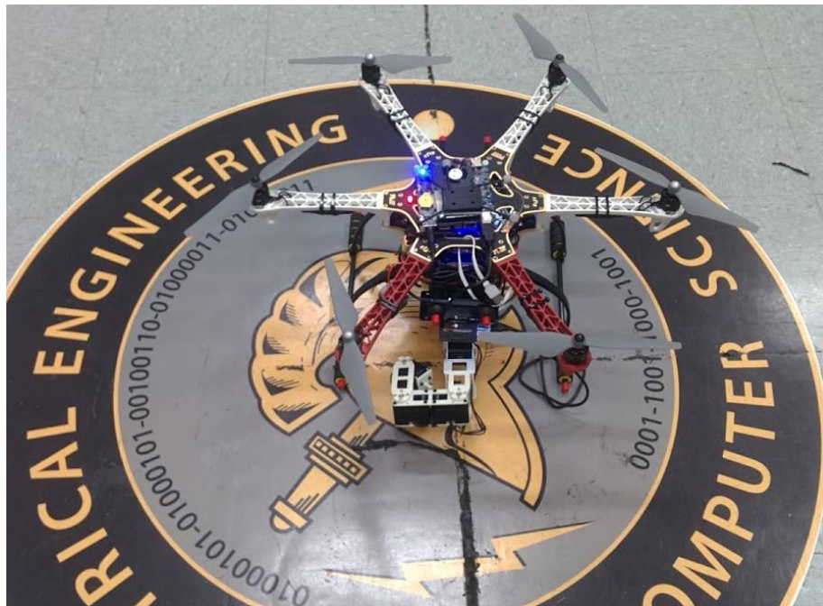
Slika 2 Letjelica s okvirom DJI F550 opremljena autopilotom Pixhawk, računalom te manipulatorom
