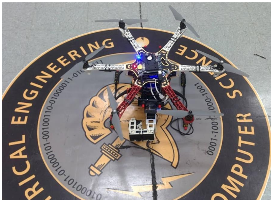
Slika 1 Letjelica s okvirom DJI F550 opremljena autopilotom Pixhawk, računalom te manipulatorom
